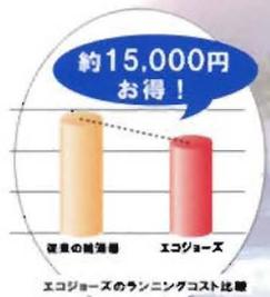
エコジョーズは排熱を利用することにより熱効率を約95%にアップさせた給湯器。熱効率が高い分、ガスの消費量を抑えられ、従来の給湯器と比べ、光熱費が年間約15,000円お得です。
